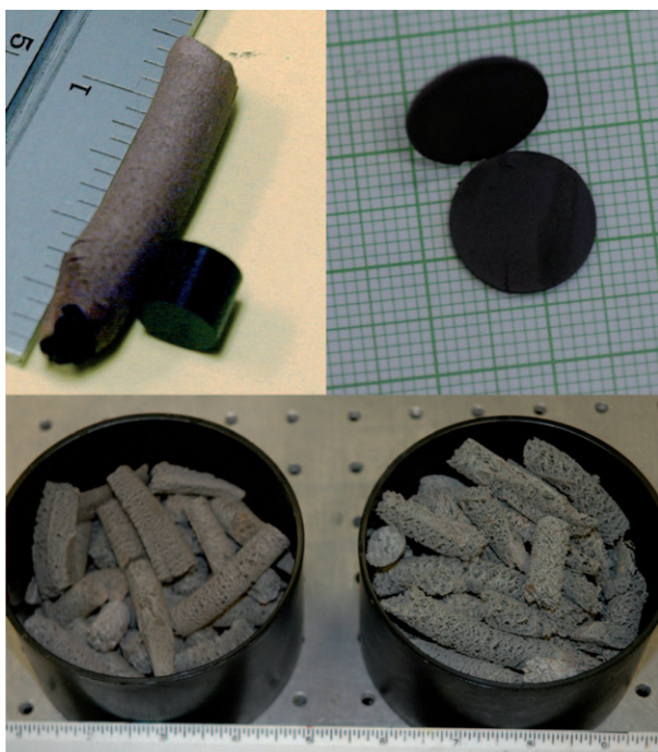
Abbildung 7. Oben links: Fe-Nanoschaum neben einem unverbrannten Pellet eines [Fe(BTA)]-Komplexes. Oben rechts: Ovale und kreisförmige Cu-Nanoschäume. Im Unterschied zu Fe-Nanoschäumen behalten Cu-Nanoschäume die Form und Größe des unverbrannten Pellets bei. Unten: Co-Nanoschäume mit Porositäten im Bereich nm bis mm.
