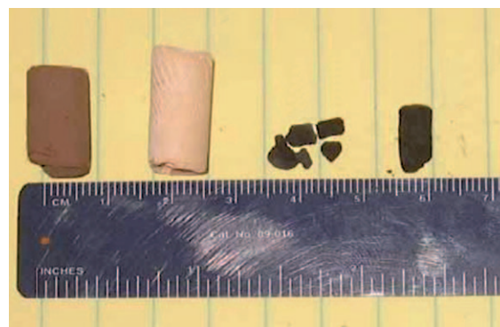
Abbildung 5. Von links nach rechts: RF-Eisenoxid-Aerogel; mit Polyisocyanat vernetztes RF-Eisenoxid-x-Aerogel; durch Nanoverhüttung hergestelltes, mesoporöses Fe-Aerogel; makroporöses Fe-Aerogel, hergestellt durch Nanoverhüttung von mit Polyisocyanat vernetzten x-Aerogelen (Bild: Nicholas Leventis).
